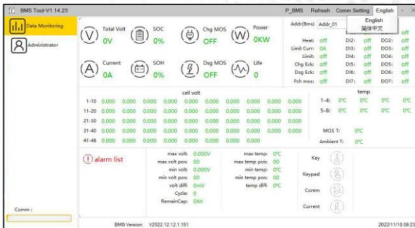
Posteriormente selecionamos a opção de Com Setting para conectarmos a BMS ao computador. A porta de conexão (PORT) será reconhecida automaticamente pelo software (no caso do exemplo COM4). Os outros parâmetros são default, Parity (None) e Boud rate (9600). Basta clicar no botão Open para iniciar a comunicação e os valores lidos da bateria serão carregados e aparecerá no canto esquerdo a comunicação estabelecida COM:RS485.
