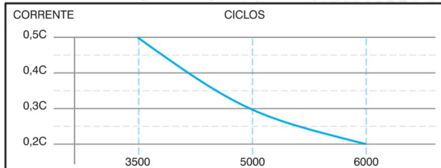
Notas: 1 - Ciclo é determinado por 1 carga e 1 descarga completa;
